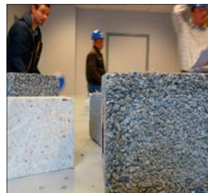
FABRICATION – Les panneaux préfabriqués sont composés d'un mélange de copeaux de bois minéralisés, de ciment et de chaux.
